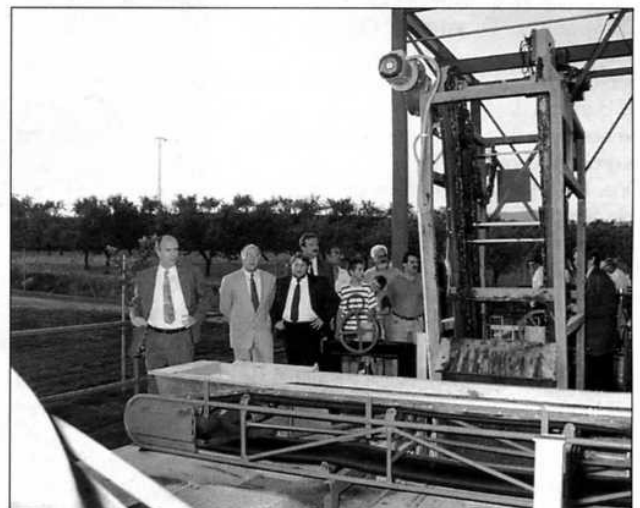
"Cintas de separación de gruesos. Estación Depuradora"
